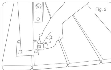
**Sugerencia:** Los suplementos de nivelación se pueden cortar fácilmente con un cincel para madera o navaja. Por favor, tenga en cuenta la seguridad durante la instalación y utilice SIEMPRE gafas de seguridad.
